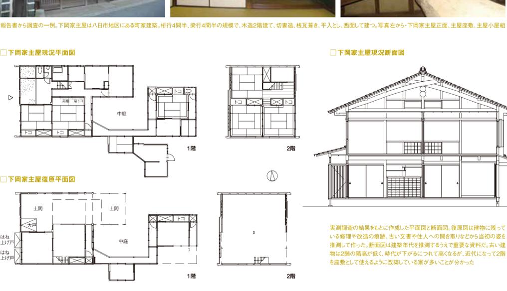
実測調査の結果をもとに作成した平面図と断面図。復原図は建物に残っている修理や改築の痕跡、古い文書や住人の聞き取りなどから当初の姿を推測して作った。断面図は建築年代を推測するうえで重要な資料だ。古い建物は2階の階高が低く、時代が下がるにつれて高くなるが、近代になって2階を産敷として使うように改築している家が多いことが分かった
